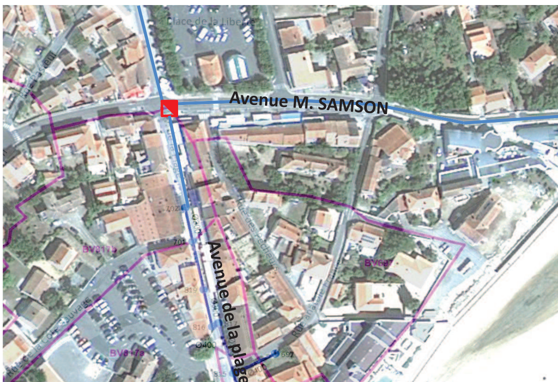
Fig. 11. Implantation du trop-plein – avenue de la plage
